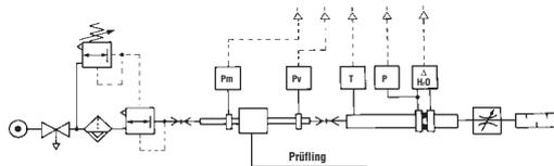
• Durchflussprüfung der Abteilung Mechanik, des Polytechnikums von Turin, mit einer Computermesseinrichtung gemäß CETOP RP50R, (ISO DIS 6358-2 konform) mit einer ISO 5167 Messblende.
